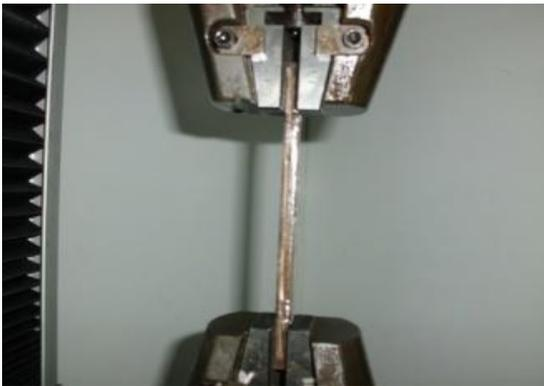
Gambar 3. Mesin Uji Tarik
