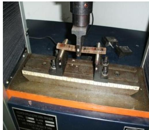
Gambar 6. Mesin uji lentur
